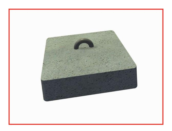
Manufatto per ancoraggio tiranti palificazione TIM, di forma tronco piramidale, realizzata in calcestruzzo semiasciutto, sottoposta a ciclo di vibrazione. Nel getto viene inserita una staffa in acciaio piegata a freddo e zincata a caldo. Materiali impiegati: calcestruzzo RcK 300; armatura Fe B44 K.
