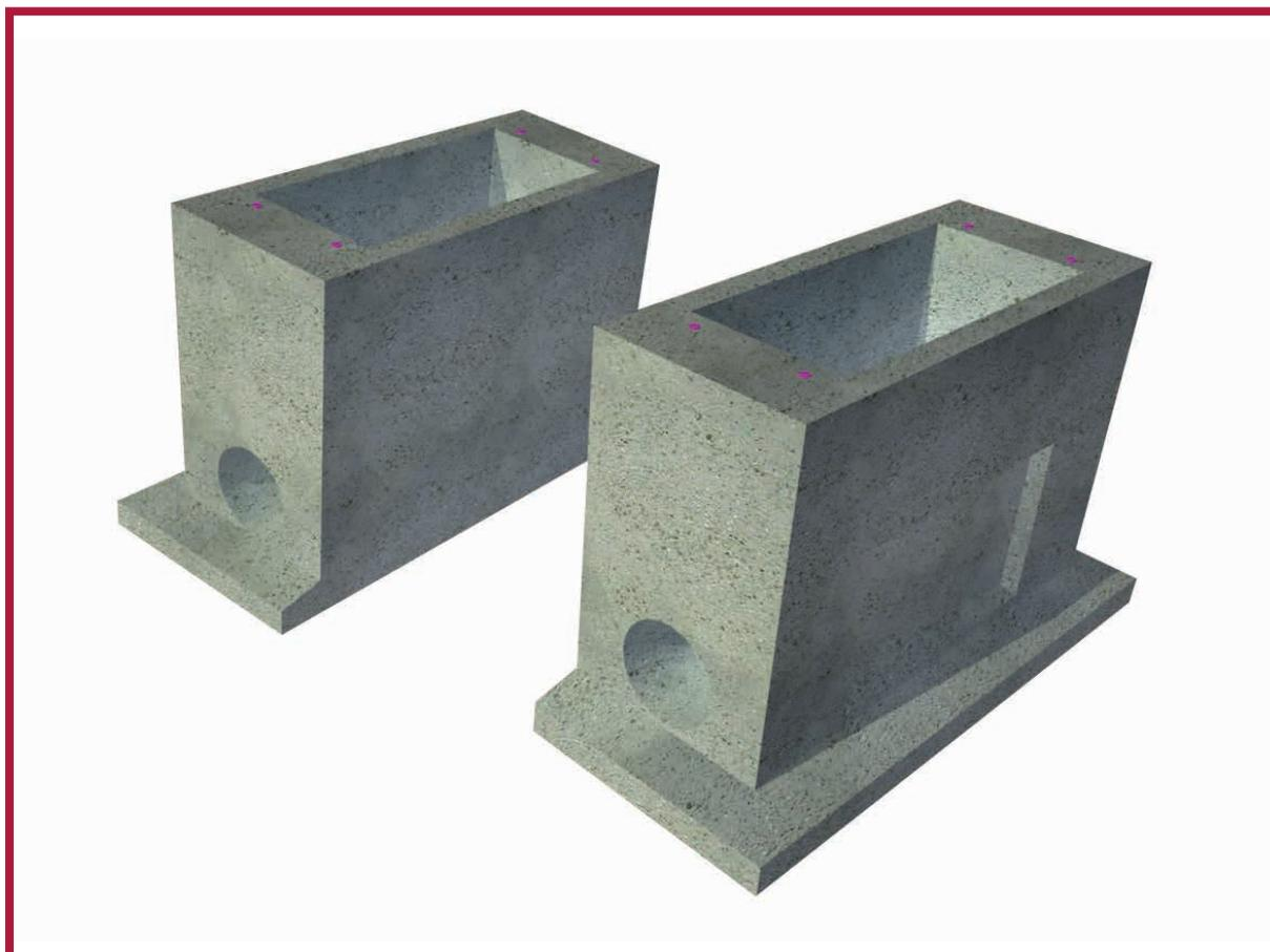
Basamento costituito da un elemento prefabbricato in cemento armato e vibrato, a pianta rettangolare e di forma parallelepipedica e provvisto di opportuni incavi per la movimentazione, con pareti a frattura per l'ingresso dei cavi e cavità interne per il passaggio degli stessi.
