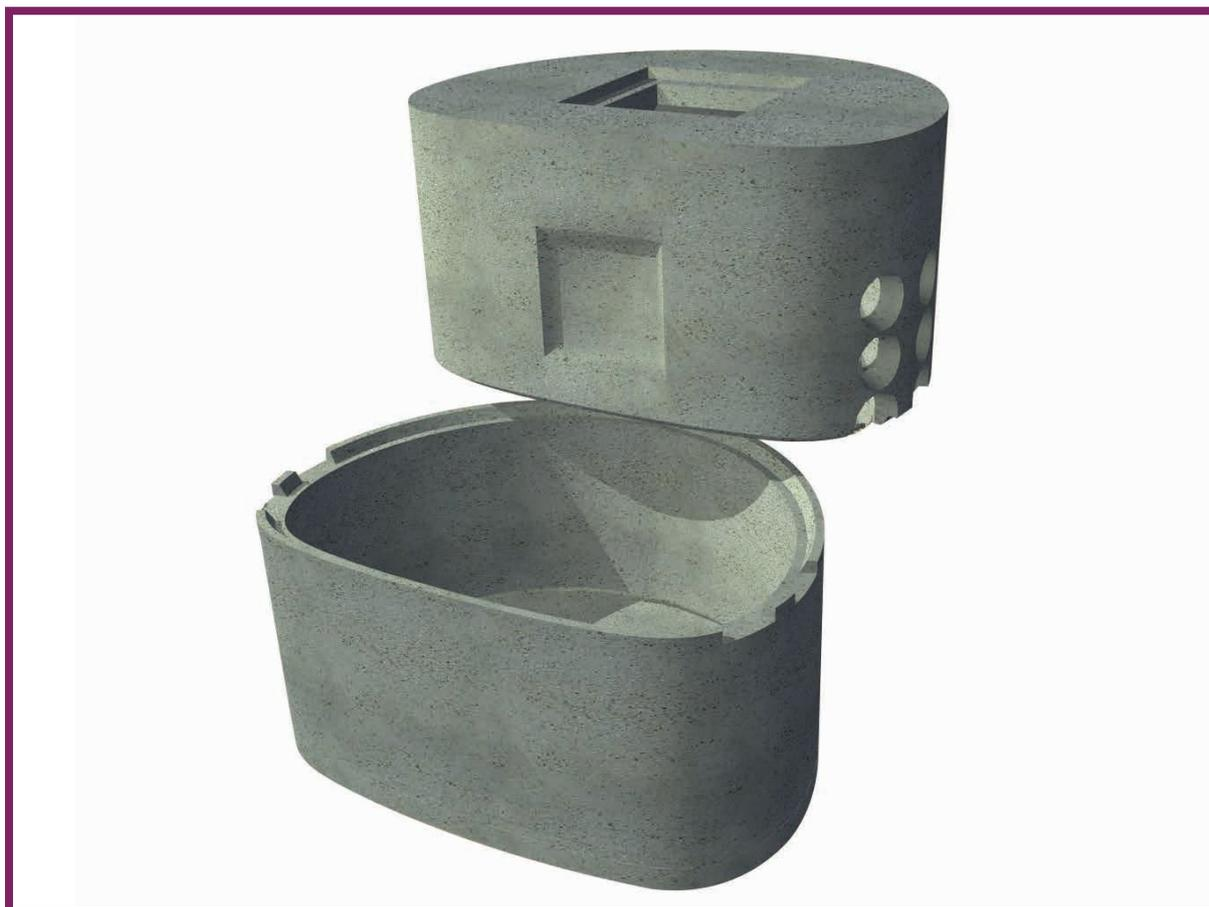
Cameretta prefabbricata per armadi ripartilinea, realizzata in calcestruzzo armato per la distribuzione di cavi telefonici. Il manufatto costituito da due gusci, speculari rispetto al piano orizzontale, è realizzato con impasto di calcestruzzo vibrato.
