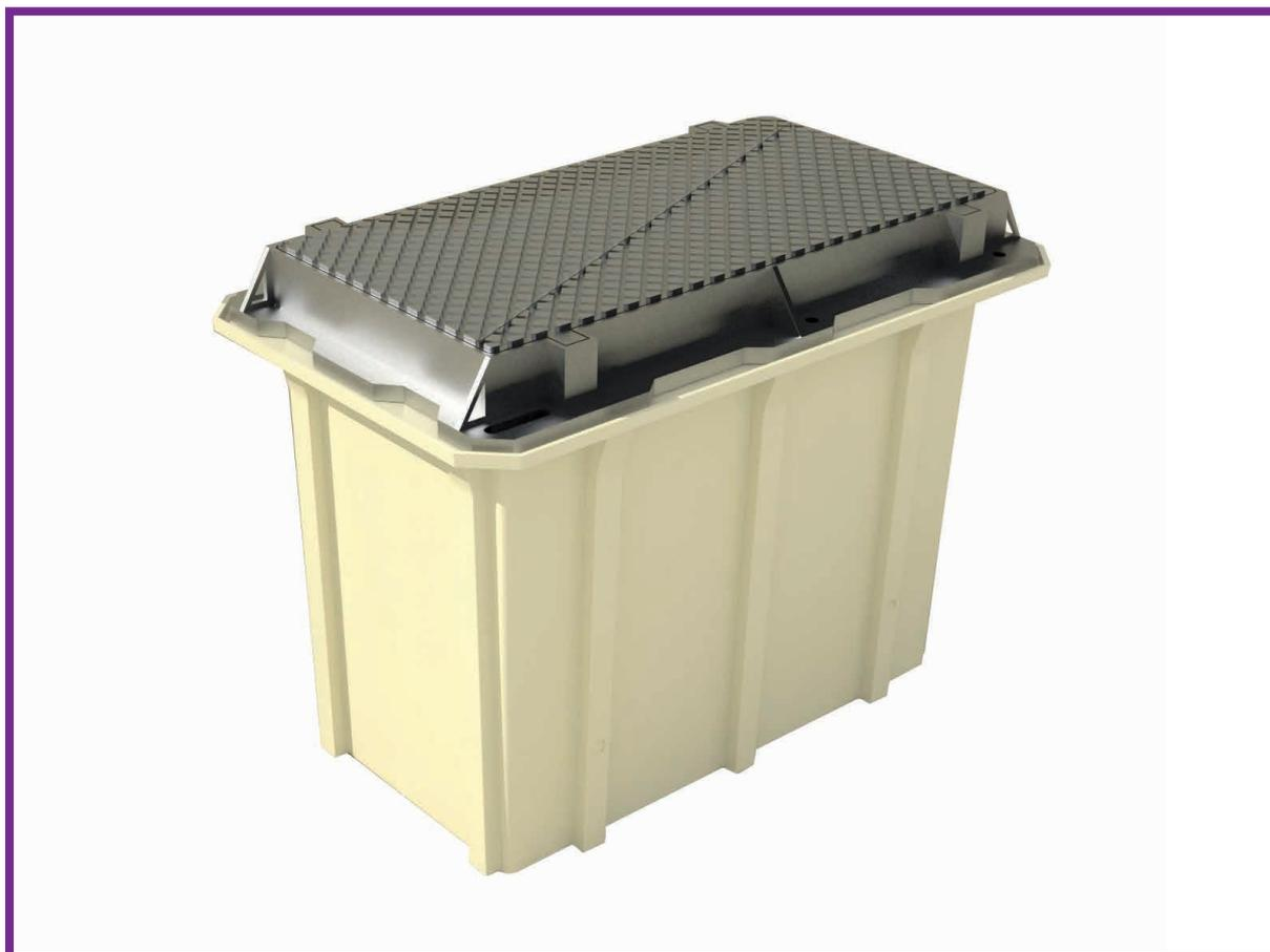
Pozzetto monoblocco in resina poliuretana compatta, con densità  $\geq 1000 \text{ g/dm}^3$ , modulo elastico a flessione  $> 1900 \text{ Mpa}$  con durezza di 77 shore D (rif. DIN 53432).
